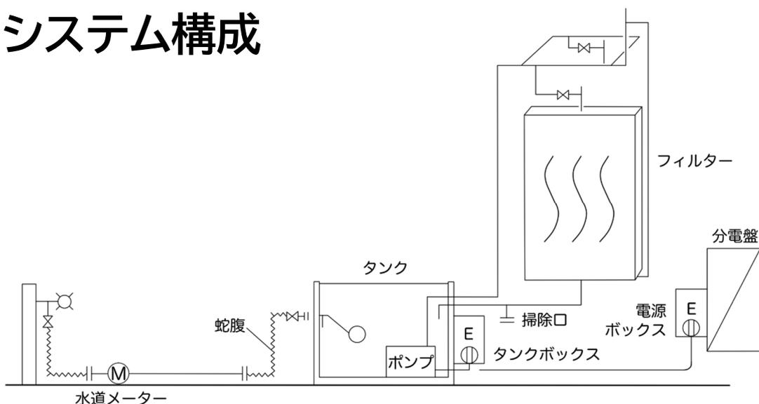
システムは、フィルターと循環水配管・タンクで構成されています。給水配管と電気配線が付随します。
